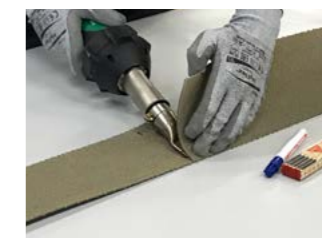
Heißluftgebläse Leister Triac AT für die Stoßverbindung mittels homogener Überlappschweißung
